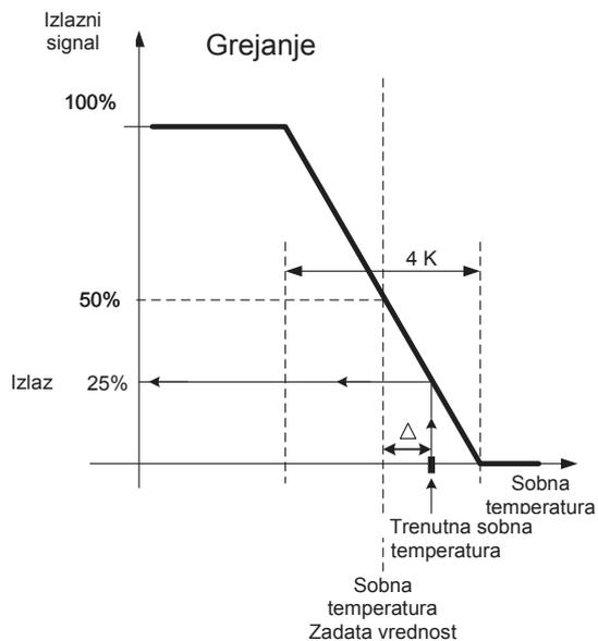
Grafikon ilustruje način rada proporcionalnog regulatora (P-regulator) za slučaj grejanja. Proporcionalni opseg ima širinu od 4 K, izlazni signal pri zadatoj vrednosti ima vrednost kao podrazumevano podešavanje parametra PE08 50 %.
