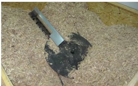
Spremnik sječke sa mješačem spojenim na transporter
