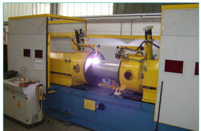
Automatsko zavarivanje bojlera od nehrđajućeg čelika
