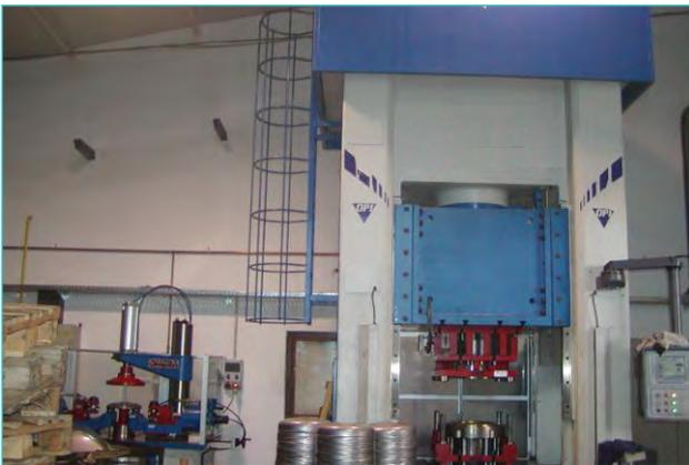
Obrada lima visokotonskim prešama
