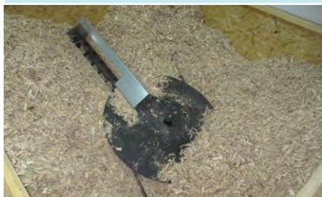
Prostorija/spremnik sječke sa mješačem spojenim na transporter
