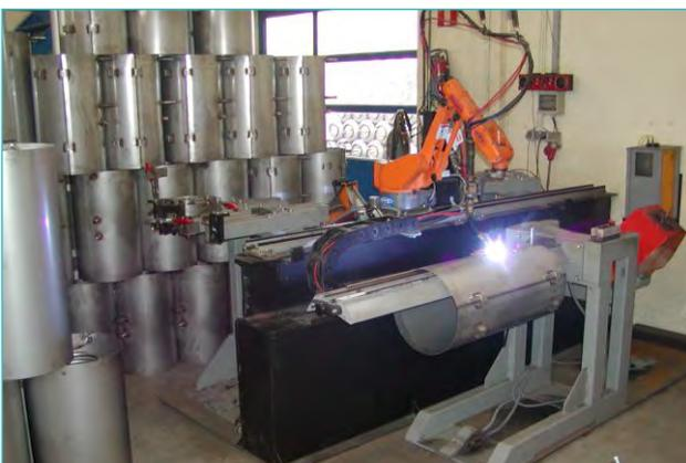
Robotsko zavarivanje bojlera od nehrđajućeg čelika
