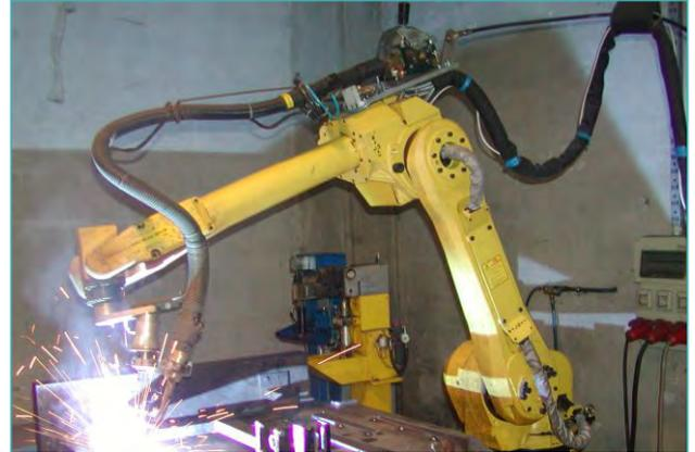
Robotsko zavarivanje kotlova
