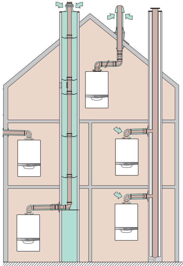
Mogućnosti izvođenja vazduho-/dimovodnih sistema
